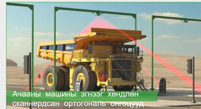
Хоёр 2D лазер сканнер, RFID болон HD камер бүхий тоног төхөөрөмж
